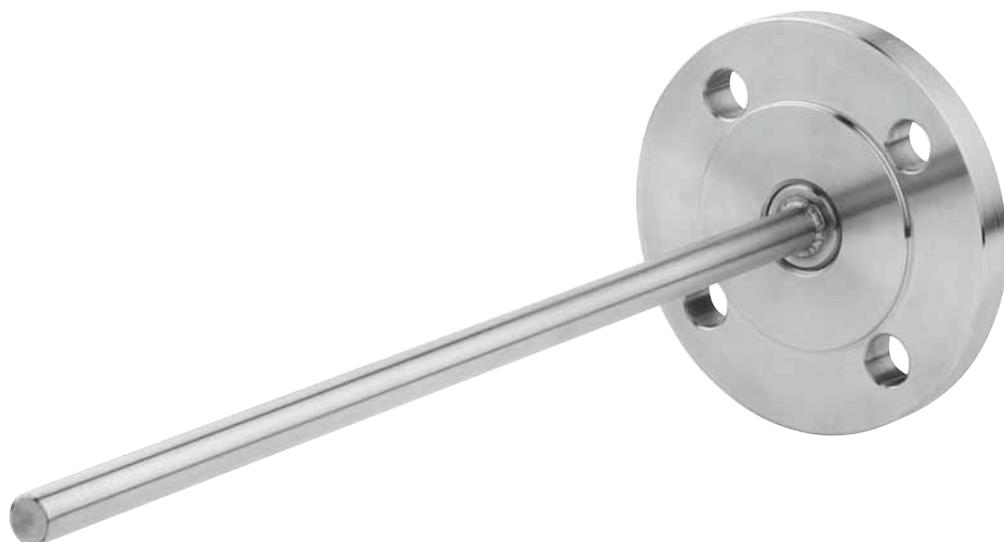
I pozzetti termometrici vengono impiegati per proteggere lo strumento di misura della temperatura da effetti corrosivi, dall'elevata pressione o velocità del fluido di processo e per consentire l'intercambiabilità dello strumento di misura per la sua ricalibrazione o la sua sostituzione, senza dover intervenire direttamente sul processo. La serie W82 è costituita da pozzetti termometrici da tubo con attacco al processo di tipo flangiato. Tali pozzetti sono adatti a carichi di lavoro medio-bassi.
